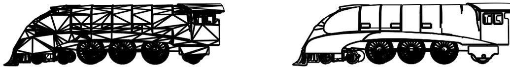
**Abbildung 5.36:** Durch Optimierungen des Modells kann das Ergebnis des Renderings stark beeinflusst werden. Zu sehen sind die Renderergebnisse ohne (links) und mit Anwendung der Methoden *autosmooth* und *unify normals* (rechts) auf das Modell.
